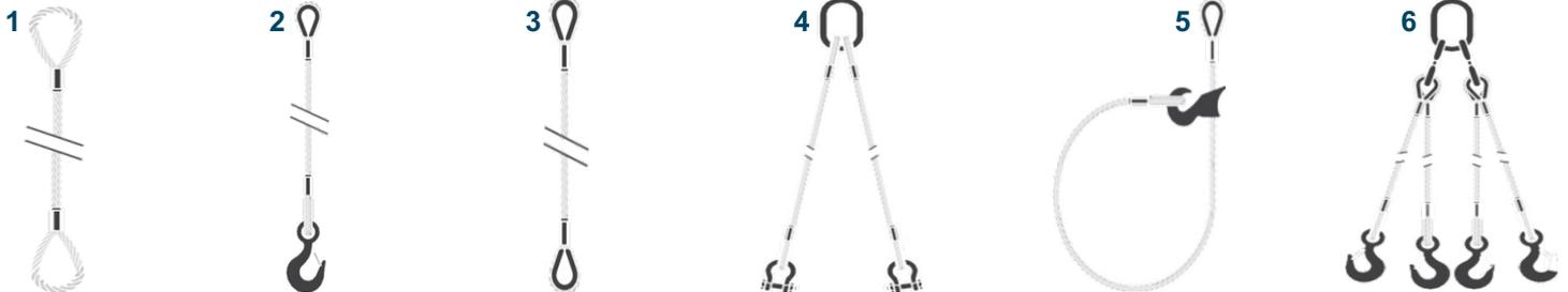
Las eslingas en cable de acero comercializadas por **INDUSTRIAS BRICA S.A.S.** están fabricadas bajo norma IRAM 5221 para garantizar el correcto funcionamiento de las mismas. Cada eslinga está identificada en su casquillo con su capacidad de izaje y número de trazabilidad para la rápida identificación
